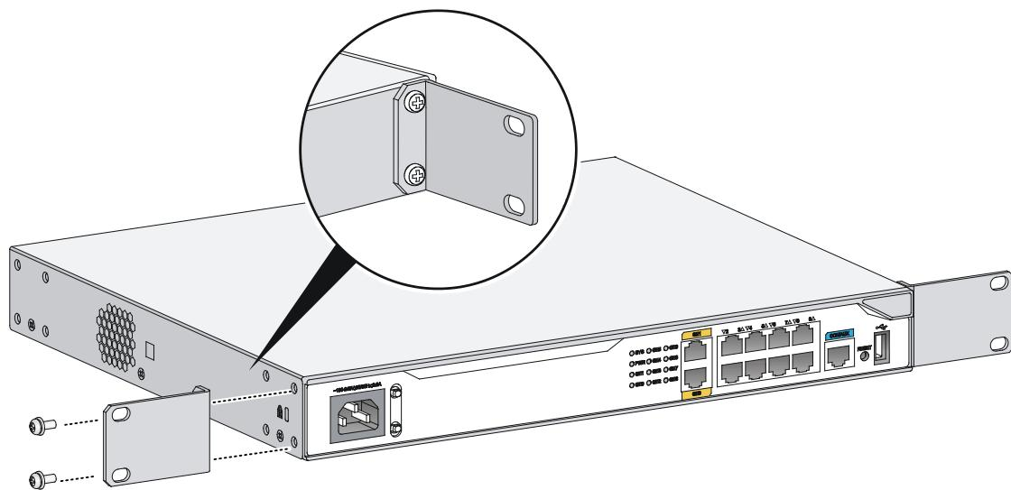
(4) 用满足机柜安装尺寸要求的 M6 盘头螺钉将设备通过左、右前挂耳固定在机架上并顺时针拧紧。
