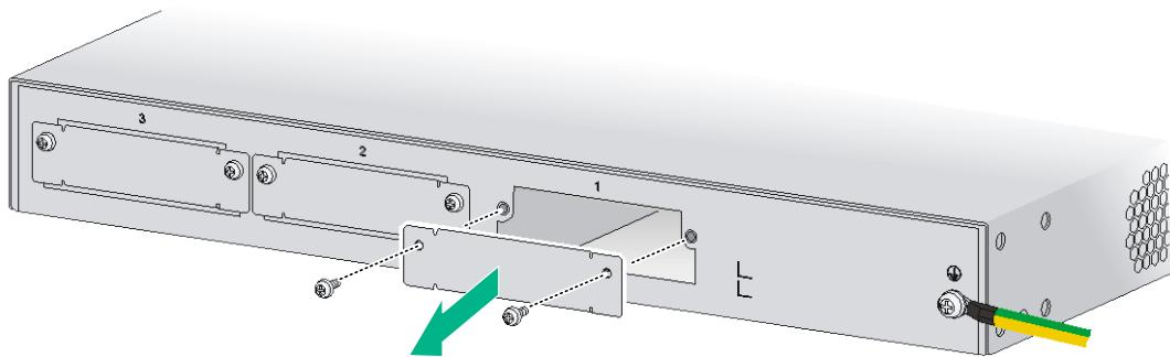
图2-11 安装 SIC 接口模块
