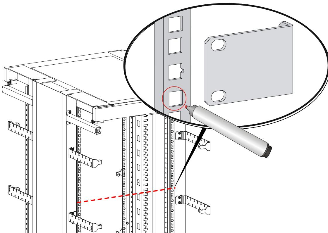
图2-5 安装浮动螺母
